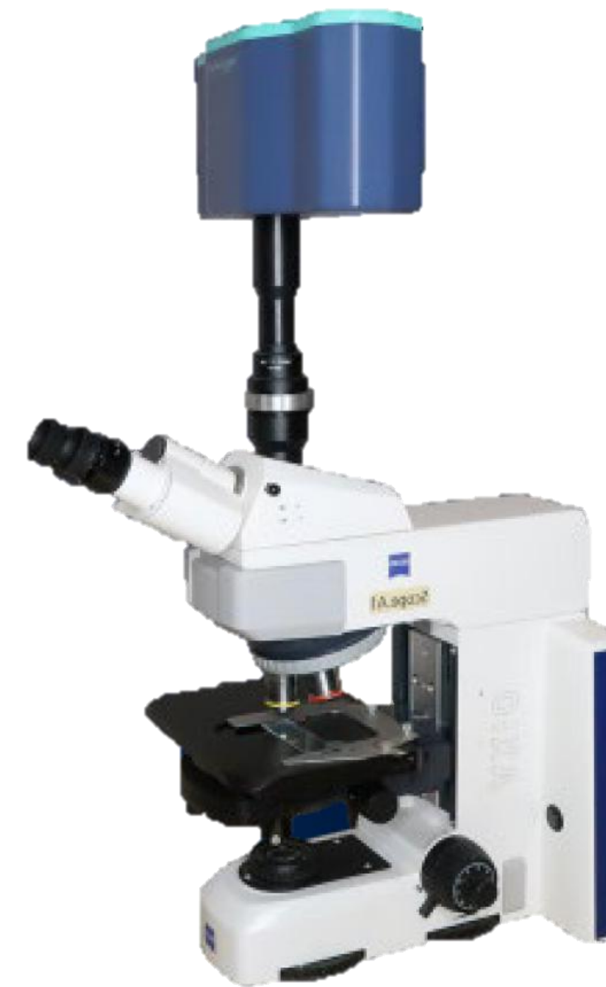
Muses9-HS mit C-mount auf einem Mikroskop
