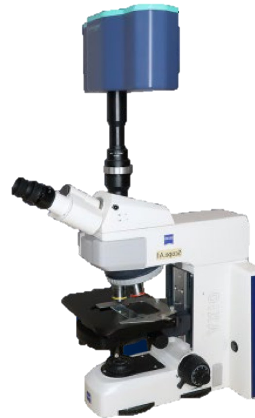
Muses9-HS mit C-mount auf einem Mikroskop
