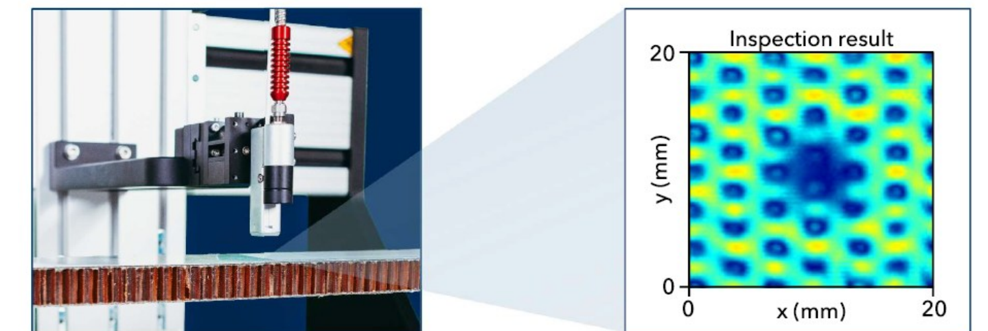
Delamination in einer Wabenstruktur
