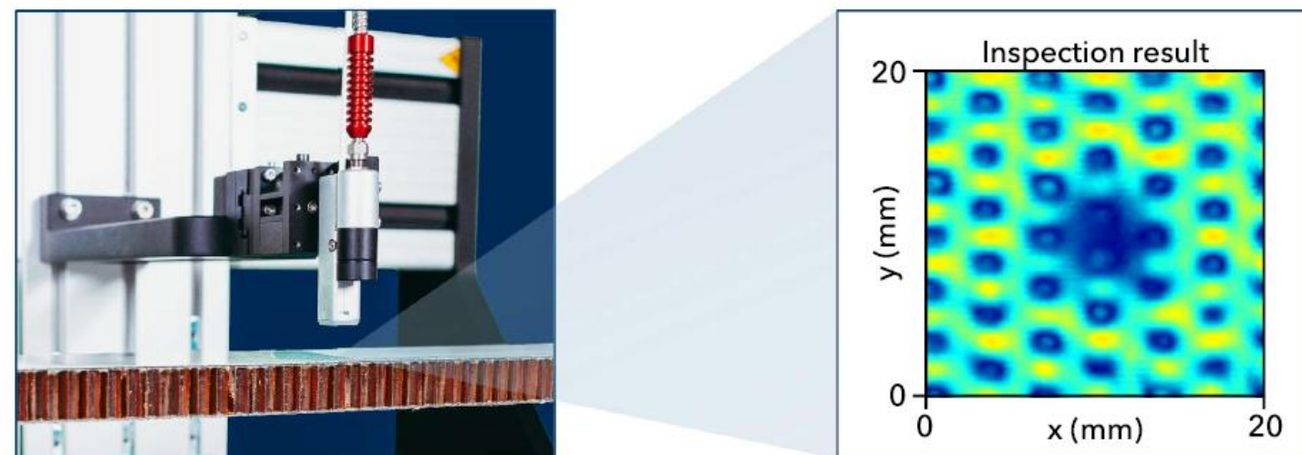
Delamination in einer Wabenstruktur
